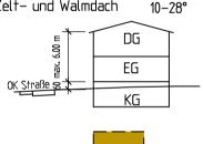
Dachneigung 10–28° max. Traufhöhe über OK KG-Decke = 6.00 m
