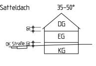
Dachneigung 35–50°, Kniestock max. 90 cm OK EG Rohfußboden max. 60 cm über OK Straße
