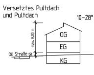
max. Firsthöhe über OK KG-Decke = 8.00 m Der Kniestock wird auf 2.00 m festgesetzt
